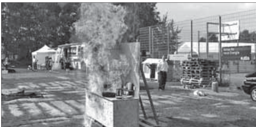
So endet der Versuch, brennendes Fett mit Wasser zu löschen
